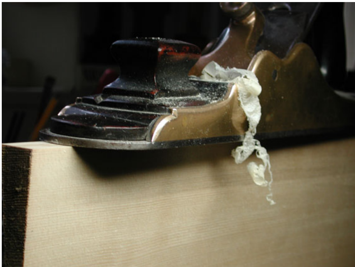
Fughobel beim Fugen einer Decke
